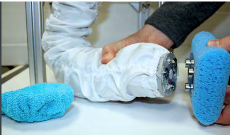
Hydraulisch betriebene „soft arms“ (hier: ein Prototyp) unterstützen in ihrem Alltag eingeschränkte ältere Menschen beim Duschen
